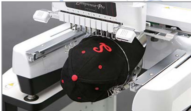
Ajuste de la gorra directamente en la máquina
