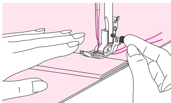
Cuando llegue al punto de un elevado espesor, baje la aguja y levante el prensatelas. Presione la punta del prensatelas hasta la línea horizontal y presione el botón negro, luego baje el prensatelas y continúe cosiendo.
