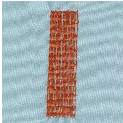
El programa de zurcido reforzado núm. 23 es especialmente adecuado para el zurcido rápido en sitios desgastados o desgarros. El programa de zurcido reforzado núm. 23 reemplaza los hilos longitudinales en todos los materiales.
